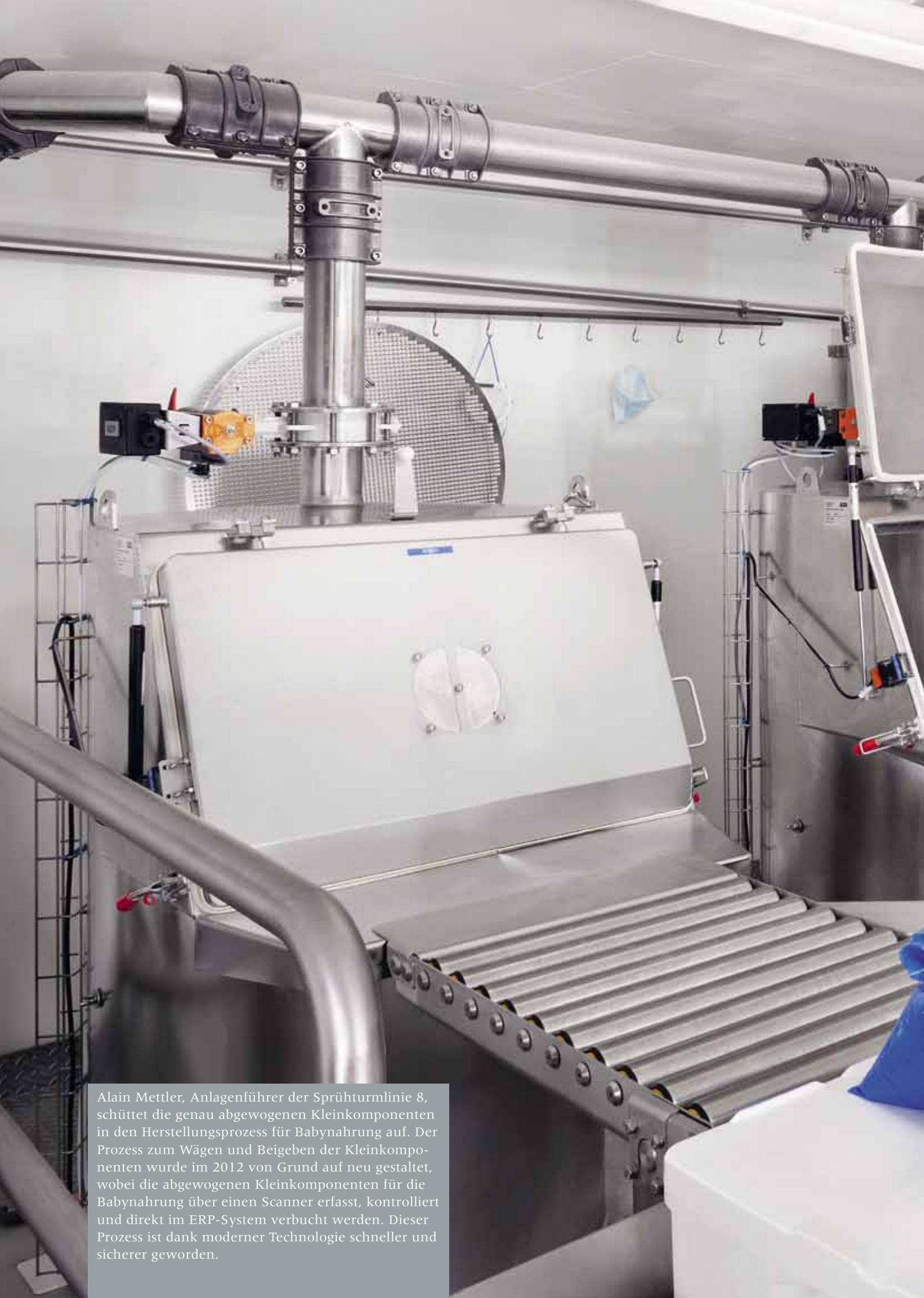
Alain Mettler, Anlagenführer der Sprühturmlinie 8, schüttet die genau abgewogenen Kleinkomponenten in den Herstellungsprozess für Babynahrung auf. Der Prozess zum Wägen und Begeben der Kleinkomponenten wurde im 2012 von Grund auf neu gestaltet, wobei die abgewogenen Kleinkomponenten für die Babynahrung über einen Scanner erfasst, kontrolliert und direkt im ERP-System verbucht werden. Dieser Prozess ist dank moderner Technologie schneller und sicherer geworden.
