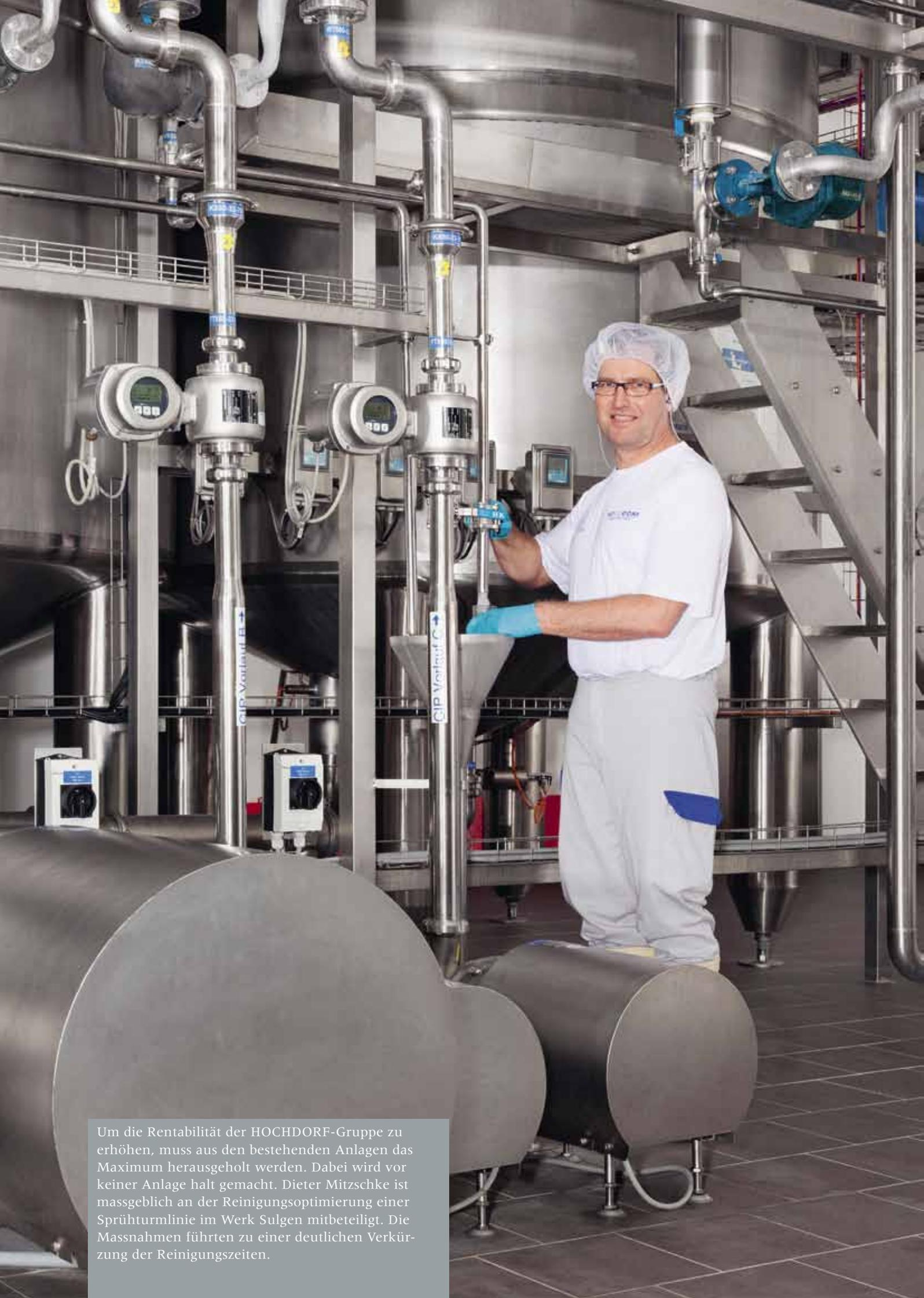
Um die Rentabilität der HOCHDORF-Gruppe zu erhöhen, muss aus den bestehenden Anlagen das Maximum herausgeholt werden. Dabei wird vor keiner Anlage halt gemacht. Dieter Mitzschke ist maßgeblich an der Reinigungsoptimierung einer Sprühturmlinie im Werk Sulgen mitbeteiligt. Die Massnahmen führten zu einer deutlichen Verkürzung der Reinigungszeiten.
